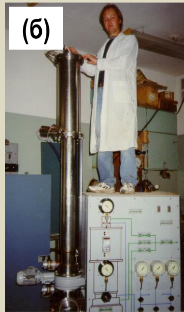
Гравитационные печи для производства стеклянных (а) и полимерных (б) оболочек
