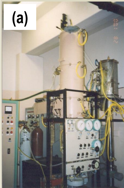
Гравитационные печи для производства стеклянных (а) и полимерных (б) оболочек
