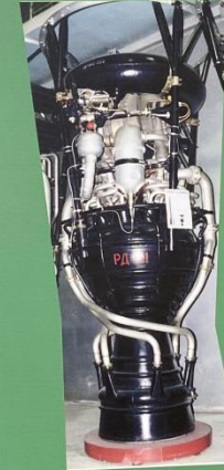
Жидкостный ракетный двигатель РД-101 Разработан в 1947-1951 гг. Устанавливался на ракету-носитель Р-2
