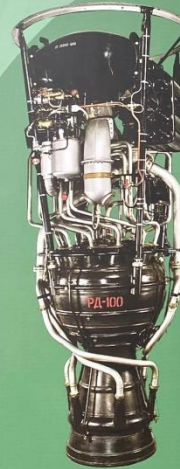
Жидкостный ракетный двигатель РД-100 Разработан в 1946-1950 гг. Устанавливался на ракету-носитель Р-1
